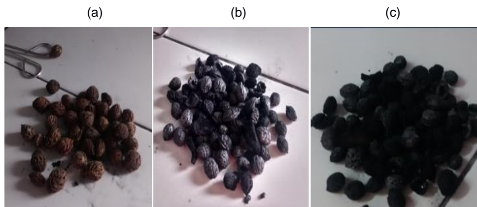
Figura 2. (a) Caroço de pêsego in natura ; (b) Caroço de pêsego carbonizado; (c) Caroço de pêsego ativado
