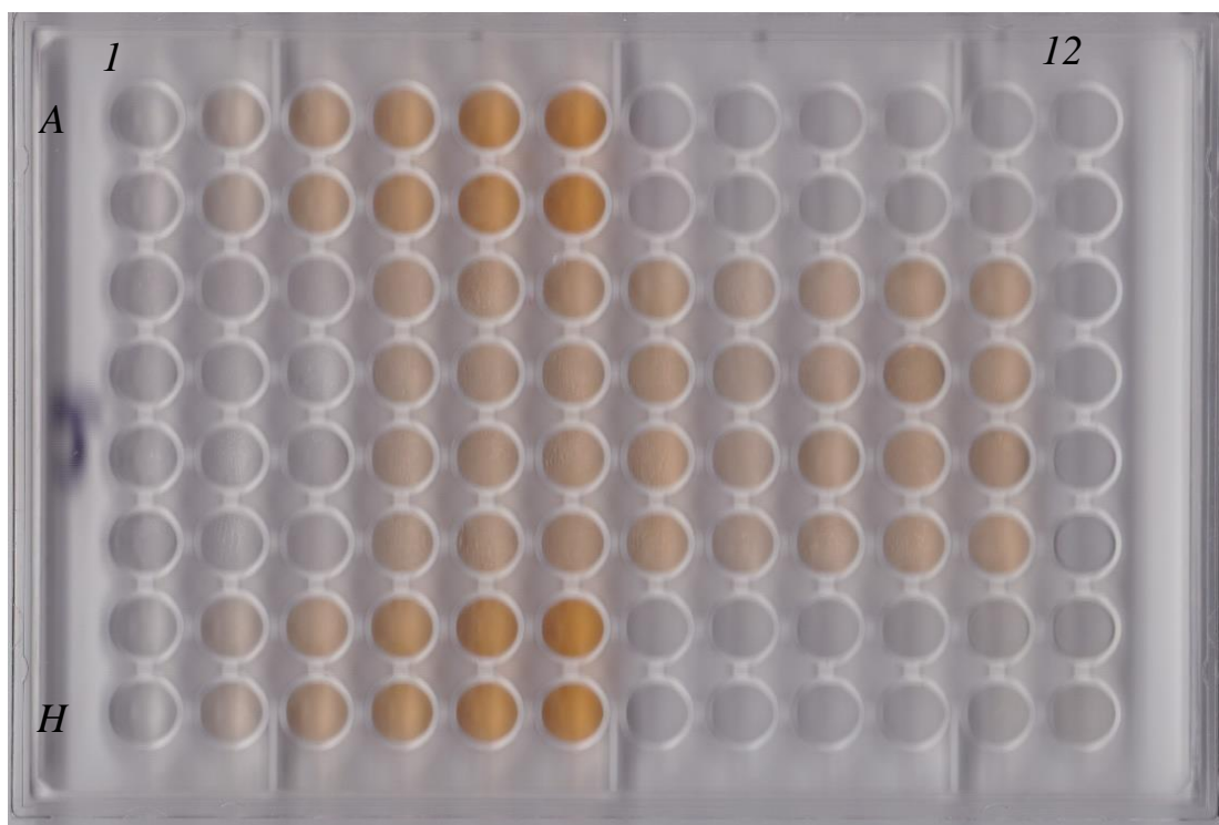
Figura 2. Ilustração de uma placa de 96 micro-poços utilizada neste experimento para determinar a constante de equilíbrio da Reação 1
