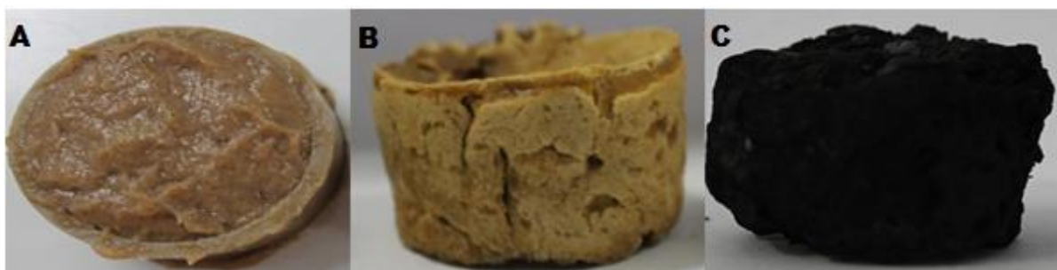
Figura 2. Massa de polpa da banana madura em molde cilíndrico de PVC (A); Briquete precursor seco (B); Briquete de carvão (C)
