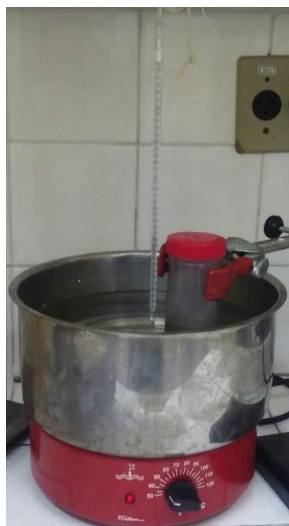
Figura 1. Sistema utilizado para o ensaio gravimétrico
