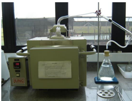
Figura 1. Mufla adaptada para captação de gases
