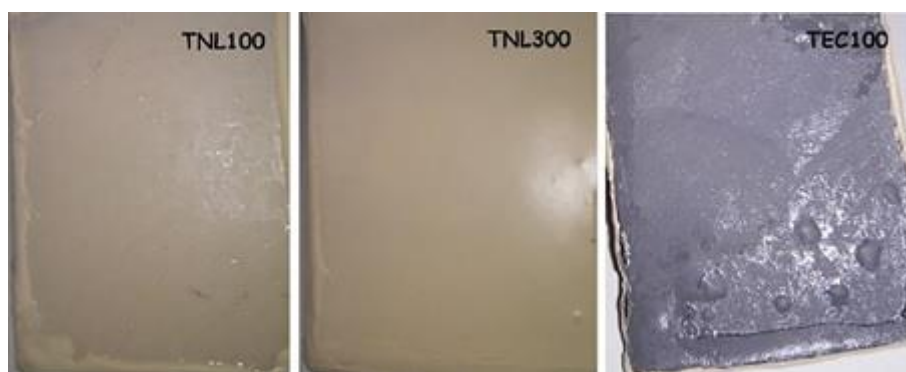
Figura 5. Corpos de provas após imersão na solução de 40 % (m/v) H_2SO_4
