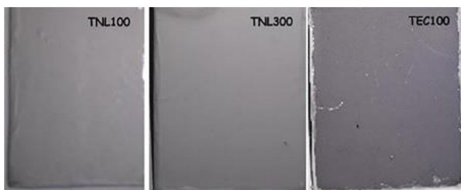
Figura 6. Corpos de provas após imersão na solução de 3,5 % (m/v) NaCl
