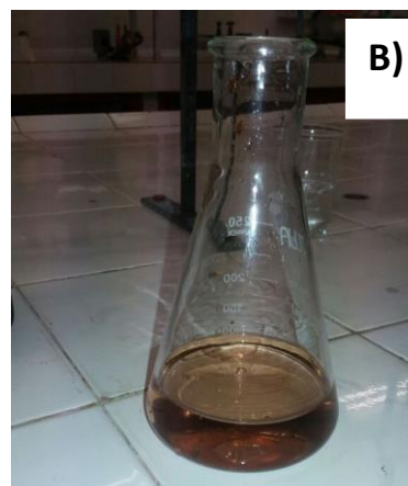
Figura 6. Solução de vitamina C titulada com \text{KIO}_3 , A) antes do ponto de equivalência (solução incolor) B) no ponto de equivalência (solução marrom-violácea)
