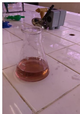
Figura 7. Ponto final da titulação de uma solução de tiosulfato com iodo. A) no início da titulação B) no ponto de equivalência
