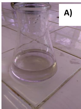
Figura 6. Solução de vitamina C titulada com \text{KIO}_3 , A) antes do ponto de equivalência (solução incolor) B) no ponto de equivalência (solução marrom-violácea)
